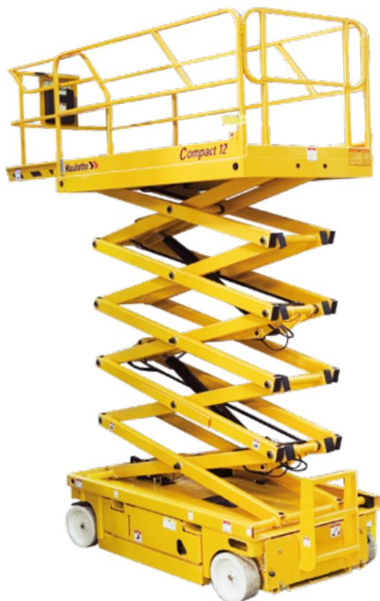
Estremamente compatta per una produttività eccezionale: traslazione alla massima altezza, cesta estensibile, grande autonomia di lavoro. Completa di un'intera gamma di allestimenti: ruote antitraccia, sblocco ruote, inclinometro, limitatore di carico in piattaforma, sistema manuale per discesa d'emergenza, sedi portaforche integrate nel telaio, anelli per sollevamento e traino, clacson, contatore.
