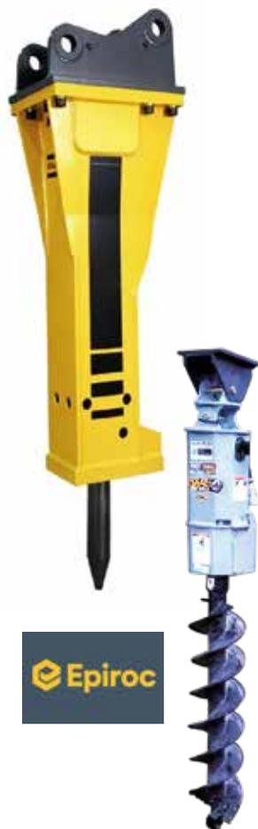
La camera con azoto in pressione sulla testa della massa battente assorbe i colpi in eccesso riducendo le vibrazioni e restituendo energia alla percussione. La valvola di regolazione permette di regolare l'energia e la frequenza dei colpi a seconda della durezza del materiale.
