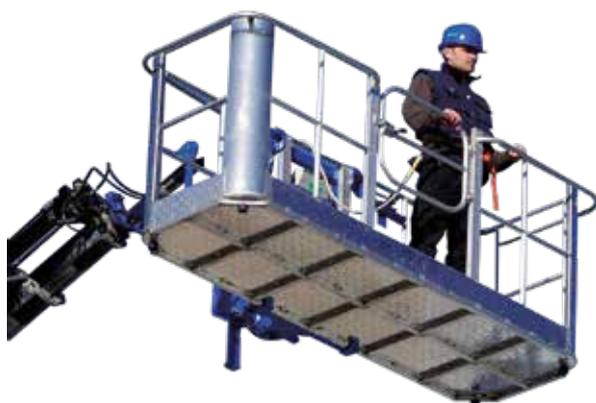
L'uso delle ceste porta persone e sollevatori telescopici permette di effettuare in sicurezza sporadici interventi di manutenzione in quota. La cesta è applicata alle forche del carrello elevatore frontale e agganciata tramite fermi di sicurezza.
