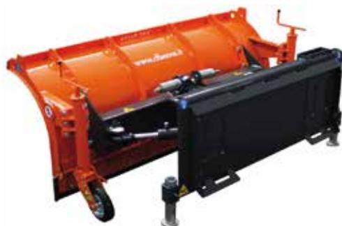
Lama sgombraneve con sistema di ribaltamento antiurto con ritorno a molla, autolivellamento orizzontale  $\pm 9^\circ$  e rotazione  $\pm 30^\circ$
