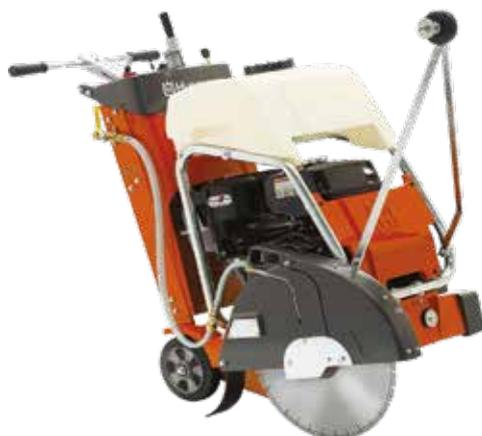
Per lavori di taglio di asfalto e cemento industriale. Motore montato su gommini antivibranti, tendicinghia a rapida regolazione. Protezione pivottante inferiore al carter copridisco. Staffa centrale con golfare per sollevamento. Sistema a ruote pivottanti, montato sull'assale anteriore. Capacità serbatoio carburante: 6,1 l.
