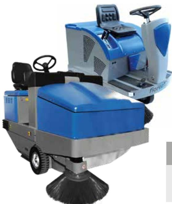
Spazzatrici uomo a bordo elettrica (S 28) ed a motore diesel (S 32). Raggiungono piste di lavoro di 1100mm/1400mm grazie alle loro spazzole centrali cilindriche.
